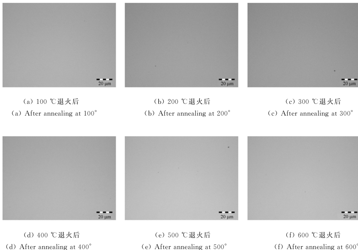
图 9 Ta_2O_5 薄膜热处理后的表面形貌( 100\times 金相显微镜)
